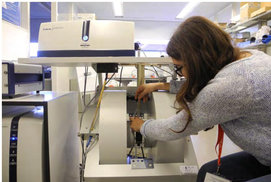
Se ha finalizado la puesta a punto y mejora del equipo ELEXSYS de Resonancia Paramagnética Electrónica para ponerlo a disposición de usuario cualificado, tanto para trabajos en temperatura ambiente como en baja temperatura, por lo que ya dispone de lo necesario para comenzar a medir con el espectrómetro por parte de los solicitantes del servicio.
