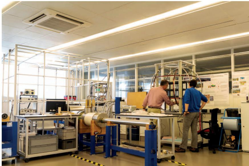
utilizado para medir la remanencia magnética de rocas, lo que permitirá el análisis de muestras de elevada intensidad, como basaltos.
